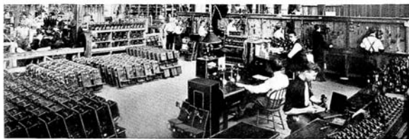
FIG. 74. — TESTING TELEPHONES — B
