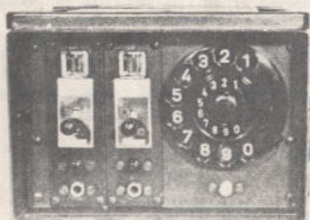
Fig 13 Automatlinjeenhet, 2-linjers — betjeningssiden
